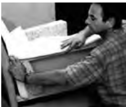
Das Polstermaterial wird hier auf dem Gestell angebracht
